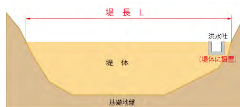
洪水吐が堤体設置の場合
