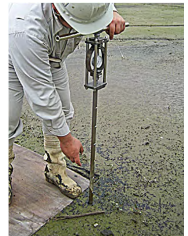
ポータブルコーン貫入試験
