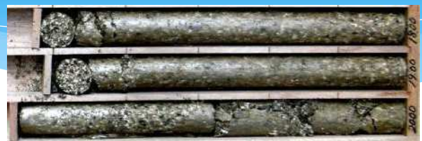
ボーリングコアで採取される風化花崗岩(鞍手町新延)
