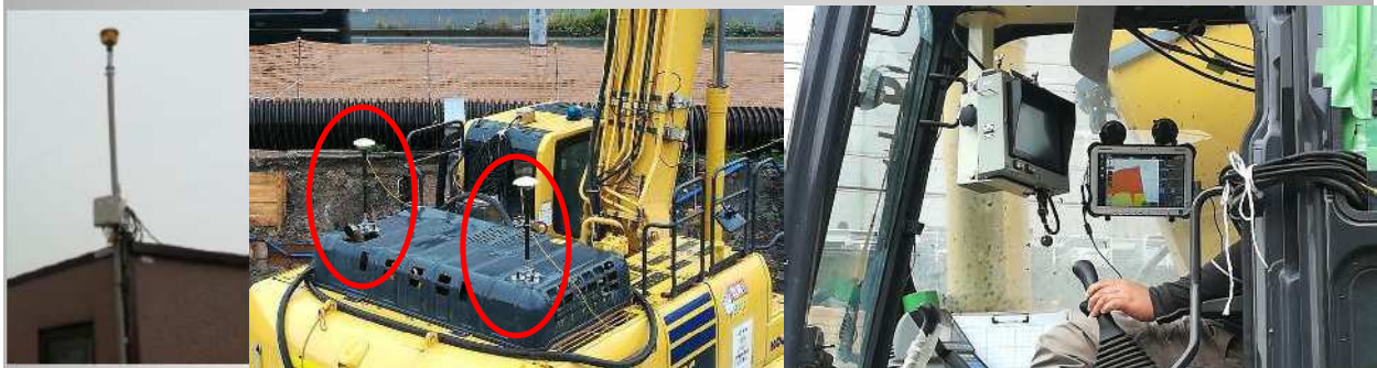
GNSS装着状況(左:基地局,右:受信機)
