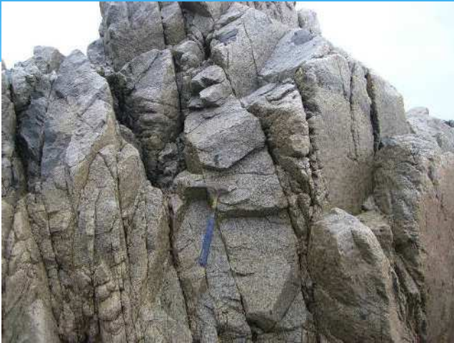
新鮮部。やや亀裂顕在化しているが、塊状・堅硬な岩盤(志賀島)
